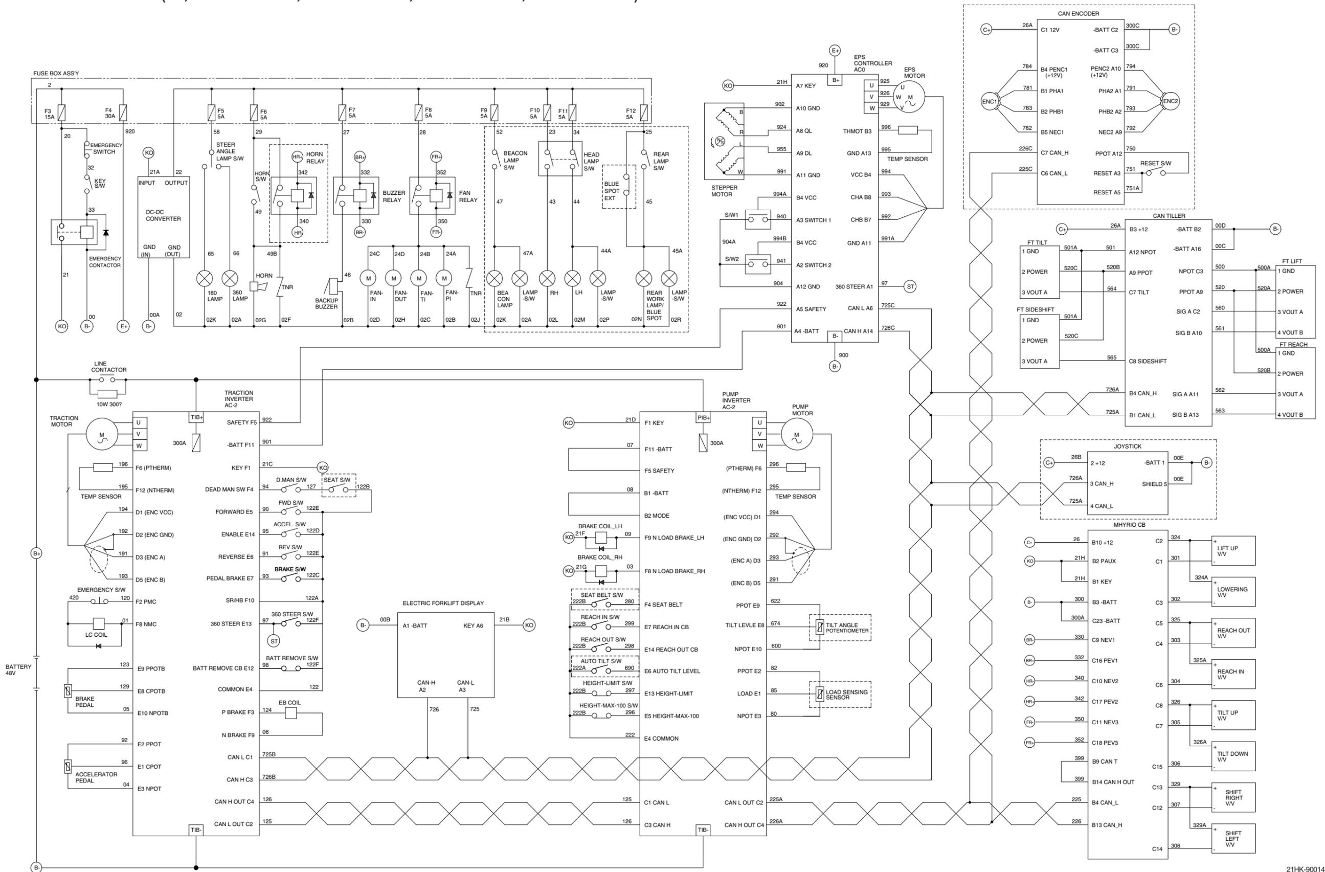
· ELECTRICAL CIRCUIT (UL, 14BRJ-9 : #35~, 16BRJ-9 : #142~, 20BRJ-9 : #80~, 25BRJ-9 : #30~)
